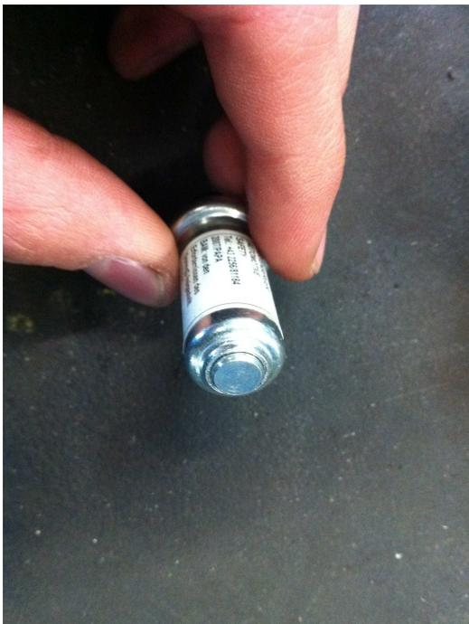
Dies ist die Gaspatrone, die den Airbag innerhalb von Sekundenbruchteilen aufbläst. (Oben als „Sprengsatz“ bezeichnet).
