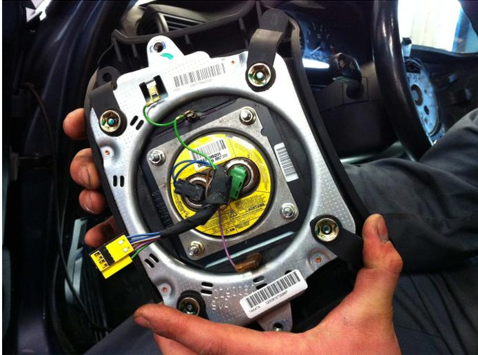
Auf diesem Bild sieht man die Verschiedenen Schaltkreise des Airbags. Er besitzt zwei Schaltkreise und zwei Sprengsätze. Ist ein Schaltkreis im Notfall defekt, zündet sofort der andere Sprengsatz. Grundsätzlich werden alle Airbags in einem Auto (heutzutage bis zu 11 Stück) minimal zeitversetzt gezündet. Denn bei der Zündung eines Airbags entsteht schon eine sehr große Druckwelle. Würden alle zeitgleich gezündet werden, würden die Insassen des Autos erheblichen Schaden nehmen.
