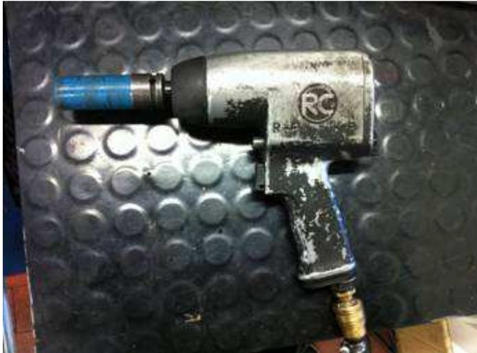
Der Schlagschrauber wird dazu benutzt, um Schrauben festzuziehen oder zu lösen. Ich möchte ihn an dieser Stelle gesondert erwähnen, weil es sich hierbei um ein pneumatisches Werkzeug handelt. Der Schlagschrauber wird ausschließlich mit Luftdruck betrieben und ist nur in Autowerkstätten zu finden.
